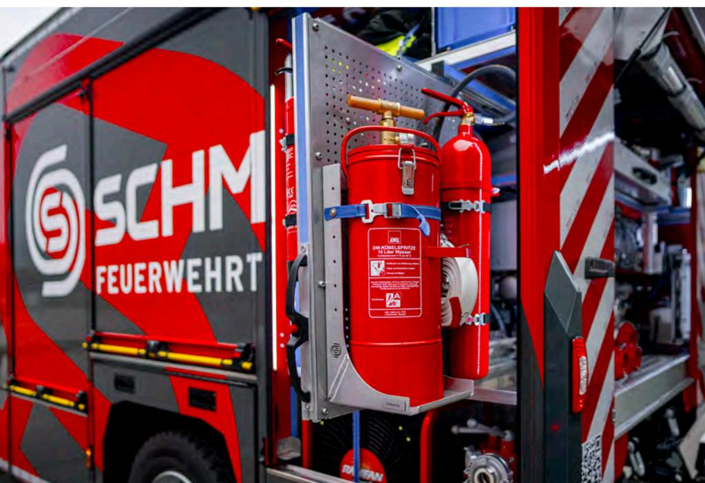
Die Lagerung der Ausrüstung erfolgt nach Kundenvorgaben, durch ein umfangreiches Portfolio an Schwenkwänden, Auszügen und Lagerungen werden die Beladungsteile einsatztaktisch und ergonomisch im Fahrzeugaufbau verlastet.
