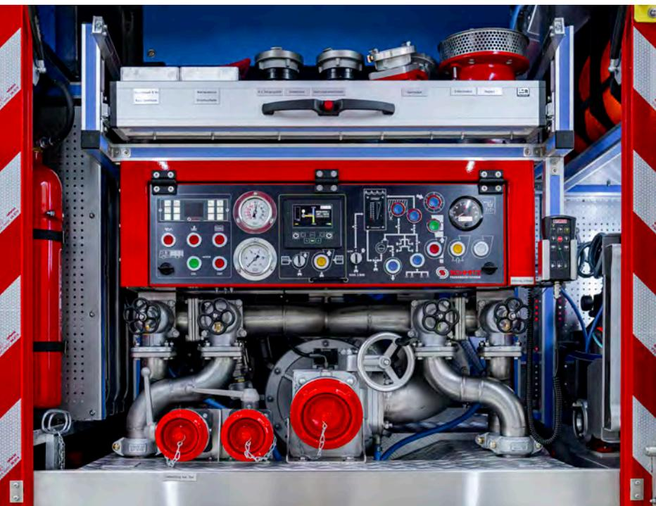
Das Herzstück eines jeden Löschfahrzeuges ist die Feuerlöschkreiselpumpe.
