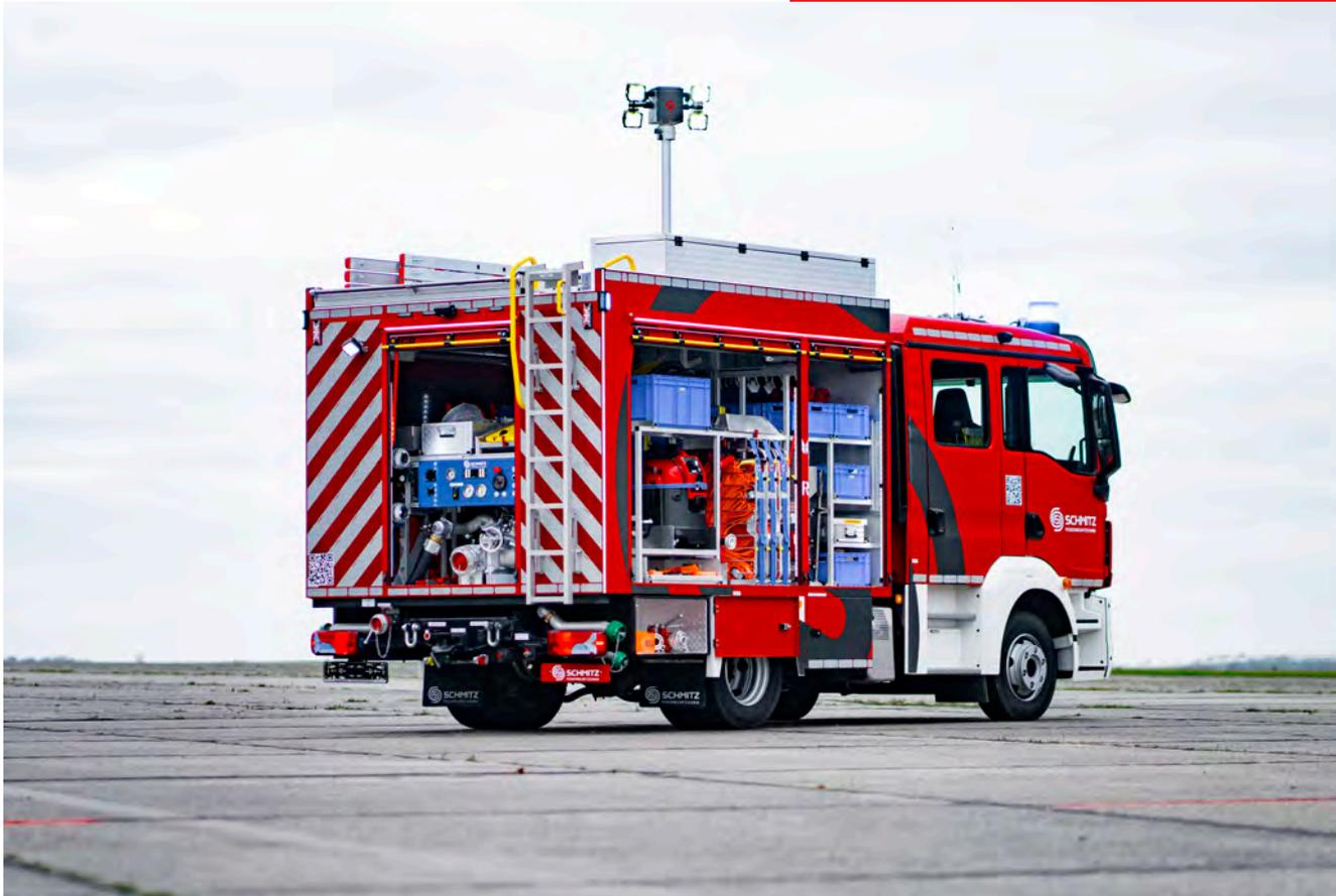
Mit dem Lichtmast kann die Einsatzstelle zusätzlich ausgeleuchtet werden.
