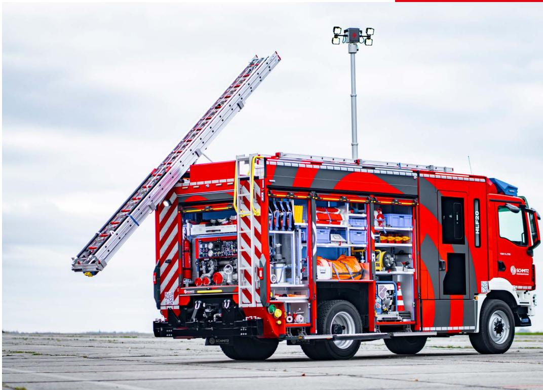
Mit dem Lichtmast kann die Einsatzstelle zusätzlich ausgeleuchtet werden.
