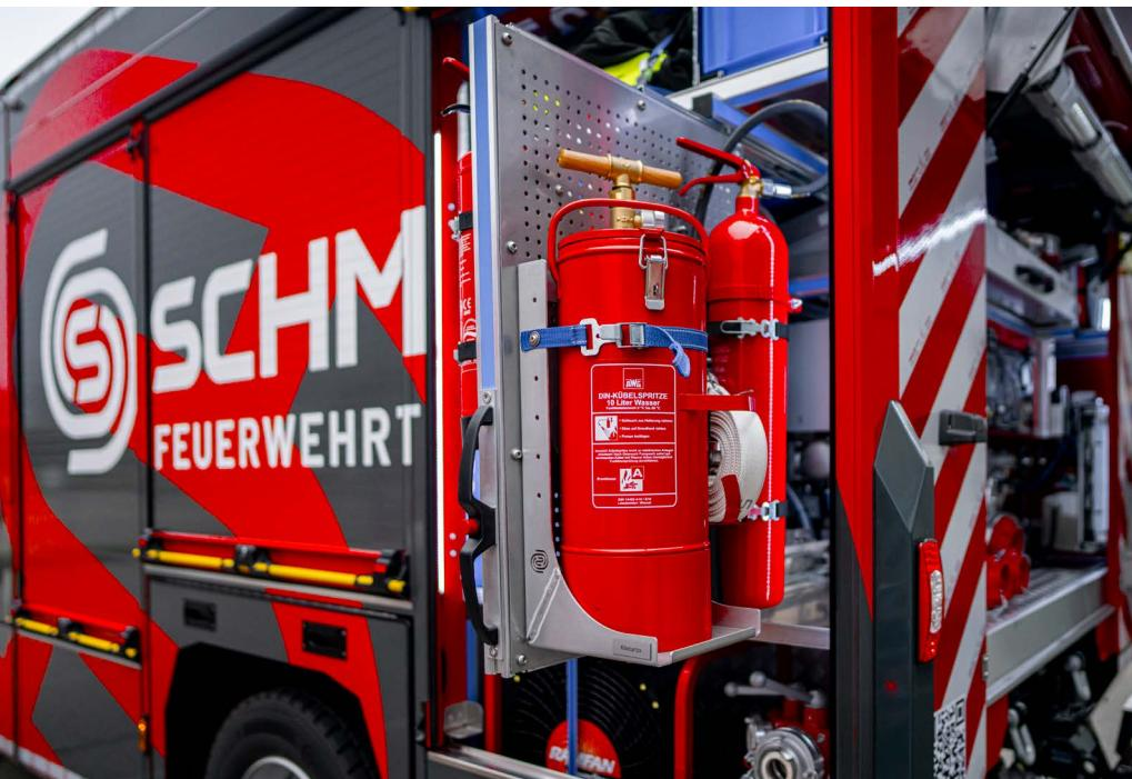
Die Lagerung der Ausrüstung erfolgt nach Kundenvorgaben. Durch ein umfangreiches Portfolio an Schwenkwänden, Auszügen und Lagerungen werden die Beladungsteile einsatztaktisch und ergonomisch im Fahrzeugaufbau verlastet.
